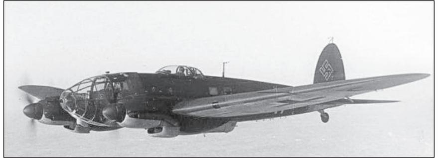
Eine He 111 in der Luft. Sie hatte eine Spannweite von 22,5 m, eine Länge von 16,4 m und war 3,4 m hoch. Zudem erreichte sie eine Höchstgeschwindigkeit von 435 km/h.
